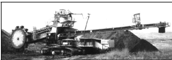
Slika 2 : Rotorni bager KRUPP C – 700S ("Kolubara – Površinski kopovi")
